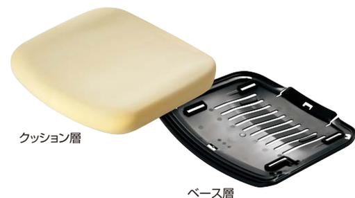
座のベース層に骨盤を支える面形状を設け、その上にクッション層を乗せることで、安定した姿勢の保持と、包み込み感の両立を実現しました。姿勢が崩れる原因のひとつである骨盤の前滑りを防止し、適切な体圧分散によって長時間の作業も快適に行えます。
